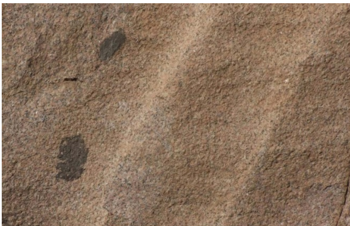
Рис. 19-ц. Твёрдые включения, срезанные с гранитом заподлицо
